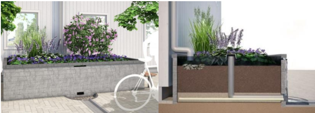
Figur 31 Exempel på upphöjd växtbädd som tar emot dagvatten från tak via stuprör (T. Lindfors, 2014)
