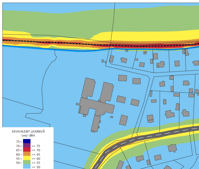
Figur 17: Ekvivalent ljudnivå 1,5 meter över markplan för alternativ med 550 meter lång bullerskyddsskärm 3 meter över rälsöverkant enligt blå linje.
