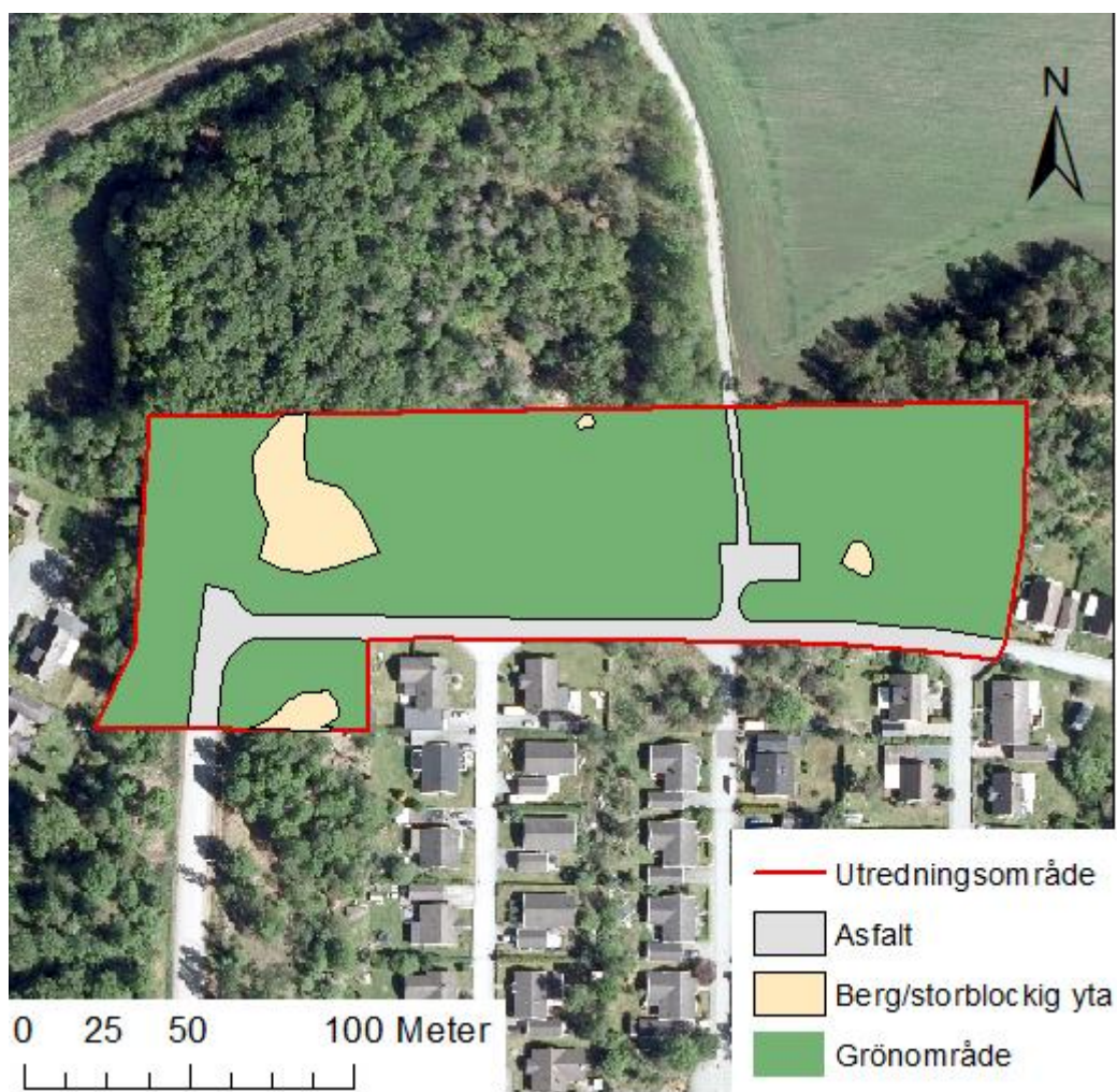
Figur 10. Befintlig markanvändning av området som har använts i flödesberäkningarna.
