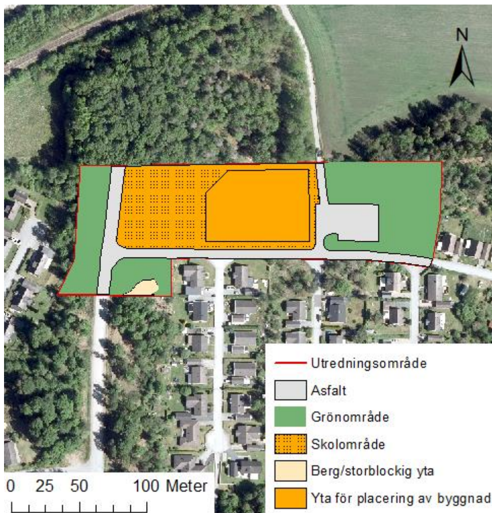
Figur 11. Planerad markanvändning av området som har använts i flödes- och magasinberäkningarna.
