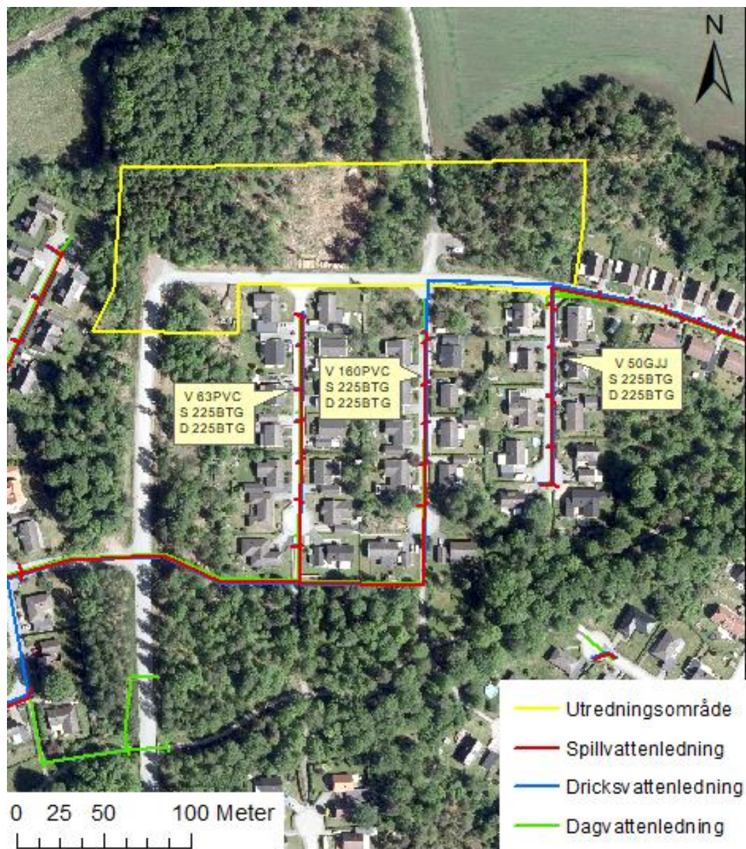
Figur 9. Befintligt VA-system omkring utredningsområdet.
