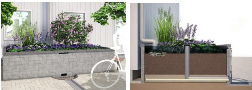
Figur 18. Exempel på upphöjd växtbädd som tar emot dagvatten från tak via stuprör (Vinnova, 2014).
