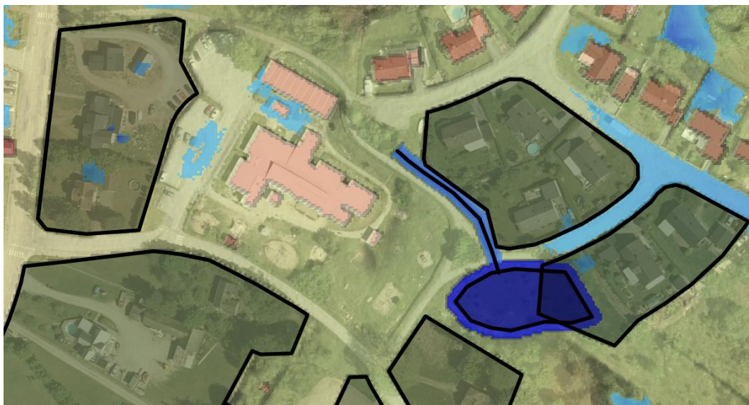
Figur 15. Alternativ för att förhindra stående vatten i lågpunkt vid skolområdet. Dike utmed gång- och cykelbana som leds till möjligt infiltrationsområde.
