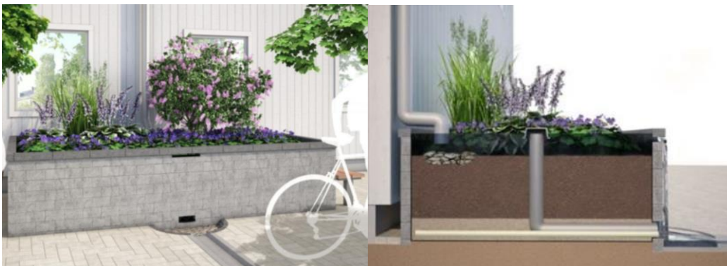
Figur 28. Exempel på upphöjd växtbädd som tar emot dagvatten från tak via stuprör (Vinnova, 2014).
