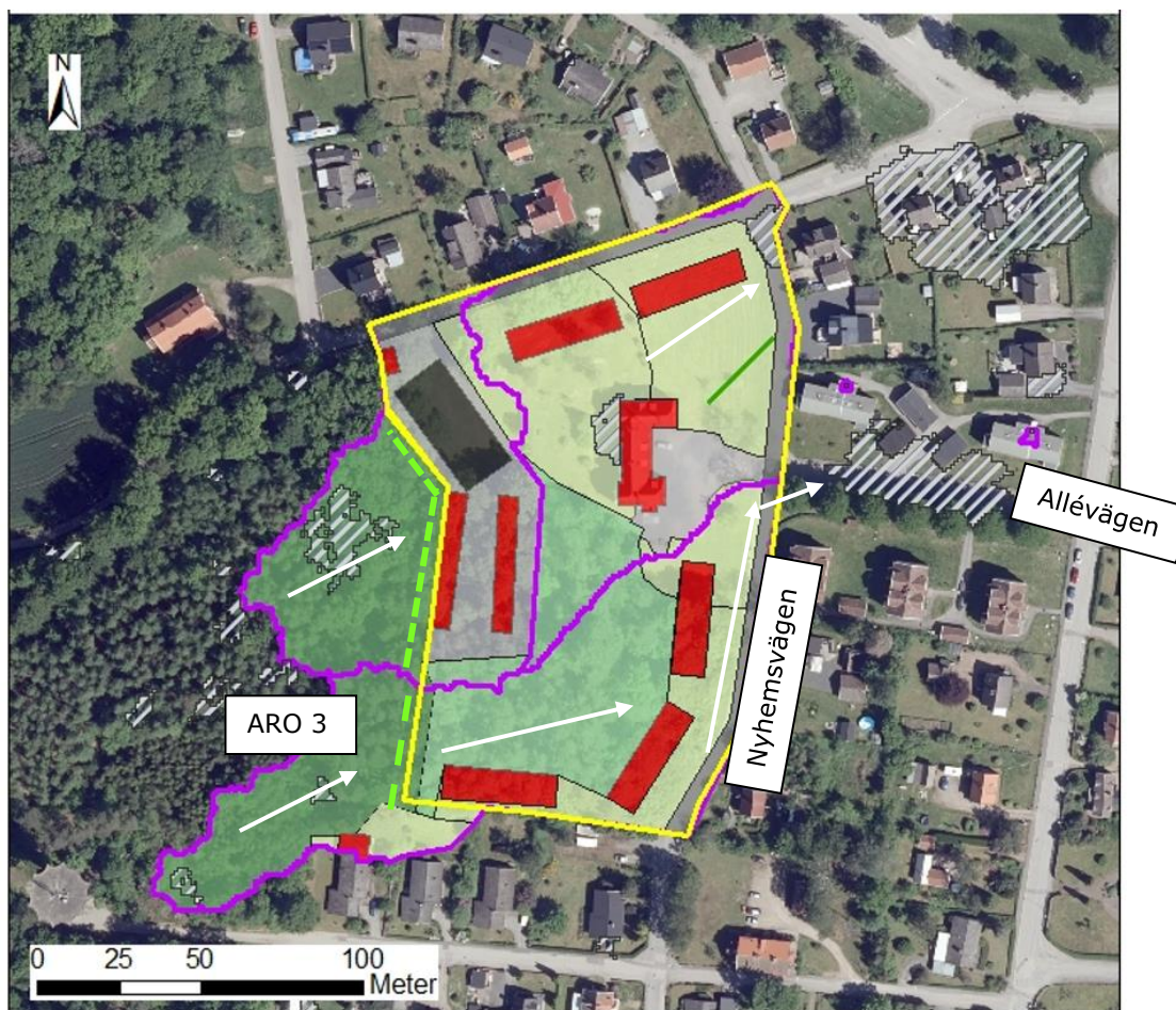
Figur 6 Detaljplanen samt avskärande diken, flödesriktningar och lågpunkter.
