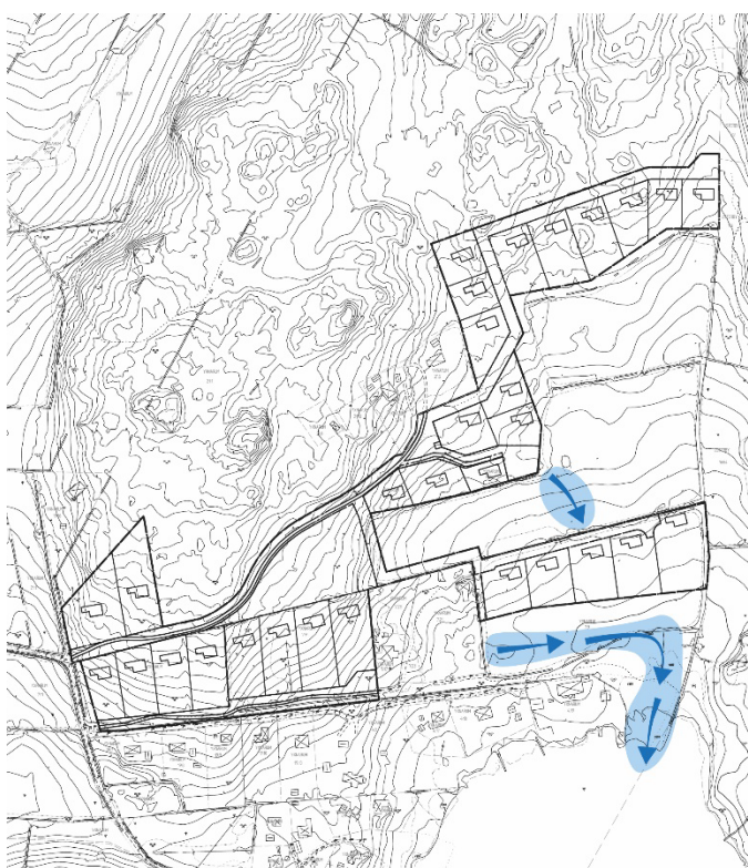
Fig. 8. Rinnvägar vid 100-årsregn. När diken enligt fig. 7 är fulla
